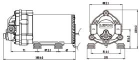
LFP6050-LFP6075W (1/4"SIDE FEMALE QUICK CONNECTOR)
